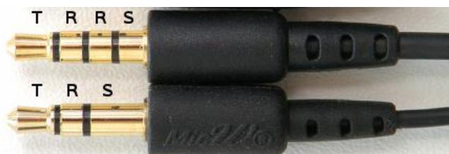
TRRS bedeutet „Tip, Ring, Ring, Sleeve“. Die vier Kontakte dienen dazu, Töne zu übertragen (Stereo links und rechts via Tip und ersten Ring) und Mikrofon-signale zu übertragen.
